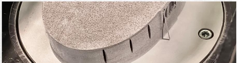
Herstellung der Rohlinge im Pulverbett mit Zuweisung unterschiedlicher Parameter an verschiedenen Bereichen des Bauteils
